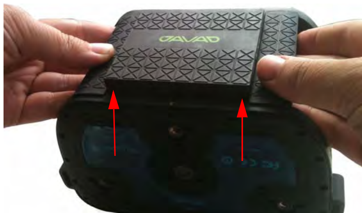
Рисунок 2-1. Выемка аккумуляторной батареи
