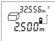
По окончании третьего измерения автоматически рассчитывается и высвечивается на дисплее объем. Последнее единичное измерение высвечивается на дисплее внизу, а конечный результат – вверх.
